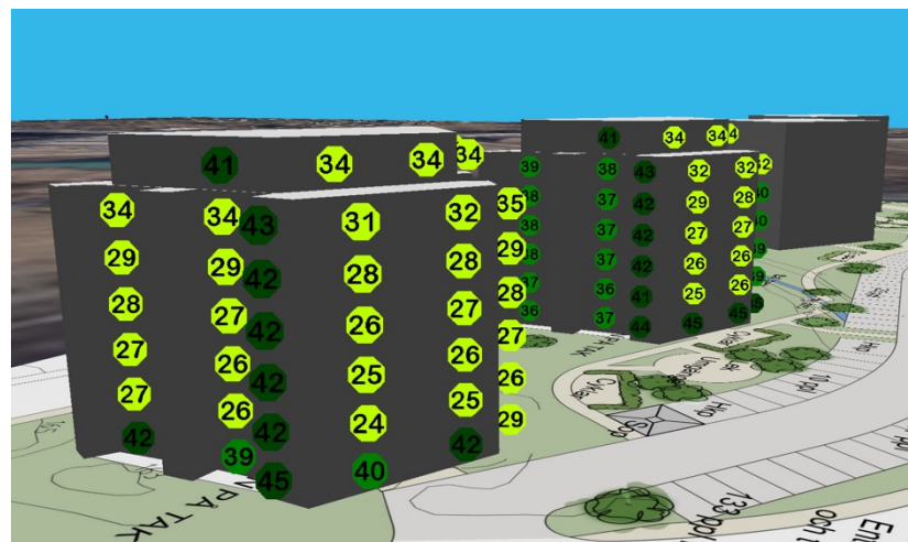
Vy över sida vänd från Cementa, kvällstid uppfylls ljuddämpad sida även på bottenvåningen
