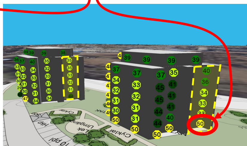
Vy 2 över sida vänd från Cementa, bottenvåningen får en del påverkan av reflekterat ljud från omgivande bebyggelse.
