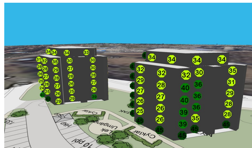
Vy 2 över sida vänd från Cementa, kvällstid uppfylls ljuddämpad sida även på bottenvåningen
